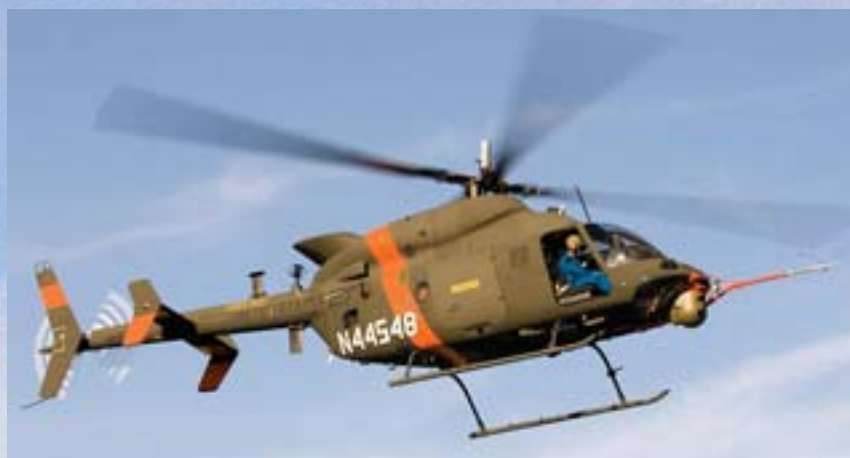
Милитаризовани дериват цивилниг вишенаменског хеликоптера Бел 407 ући ће у наоружање Авијације КоВ САД као наоружани извиђачки хеликоптер (енглеска скрћеница ARH користи се као ознака програма). Према плановима производње од 2007. до 2013. године биће испоручено 368 летелица. (фото- Bell)
